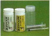
ろ過などの前処理を必要とせず、現場で簡単に土壌診断が可能。絞り汁で植物体中の硝酸含有量を測定することもできます。(みどりくんN使用)
